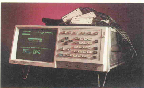
Der Bitmuster-Generator 8175A von Hewlett-Packard mit einer Ausgangsfrequenz von maximal 100 MHz erzeugte die Signale für den Test.
