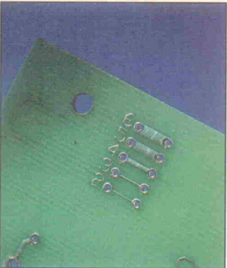
Bild 5. Ein kleiner Test 'am Rande' kann hilfreich sein, die Umsetzung von Leiterbahnbreiten beurteilen zu können.
